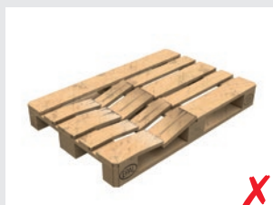
Schäden an mehr als 3 Bauteilen
