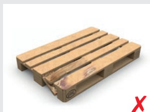
Bruch eines Querbrettes
